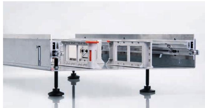
Das 3-Kammer-Prinzip sorgt für eine klare Ordnung. Die beiden äusseren Kammern sind für die Leitungsführung gedacht. In der mittleren Kammer werden die Energie- oder Datenkabel ein- resp. ausgesteckt. Ab der Breite 400 mm sind die Kanäle asymmetrisch, damit auch grosse Mengen von Datenkabeln verstaut werden können.
