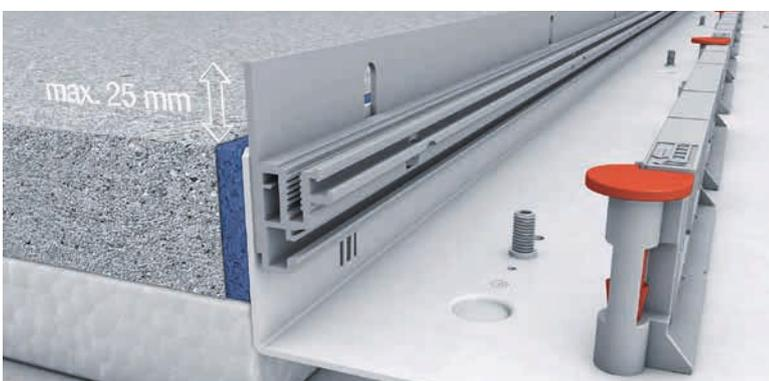
Die im Kanalunterteil integrierte Anschlagkante lässt sich bis zu einer Bodenbelagsstärke von 25 mm herausfahren.
